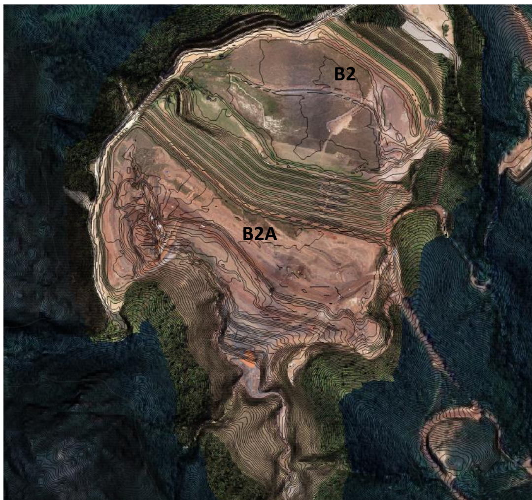
Figura 8.10 – Levantamento altimétrico (curvas de 1m) do reservatório (Doc. 11), sobreposto à imagem atualizada das Barragens B2 e B2A (Ago/2023).
