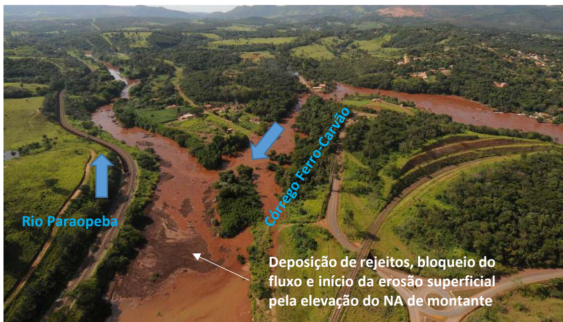
Figura 8.27 – Exemplo da deposição de rejeitos na calha do Rio Paraopeba pela mobilização dos rejeitos da Barragem B1 (Fonte: Estado de Minas, 2019).
